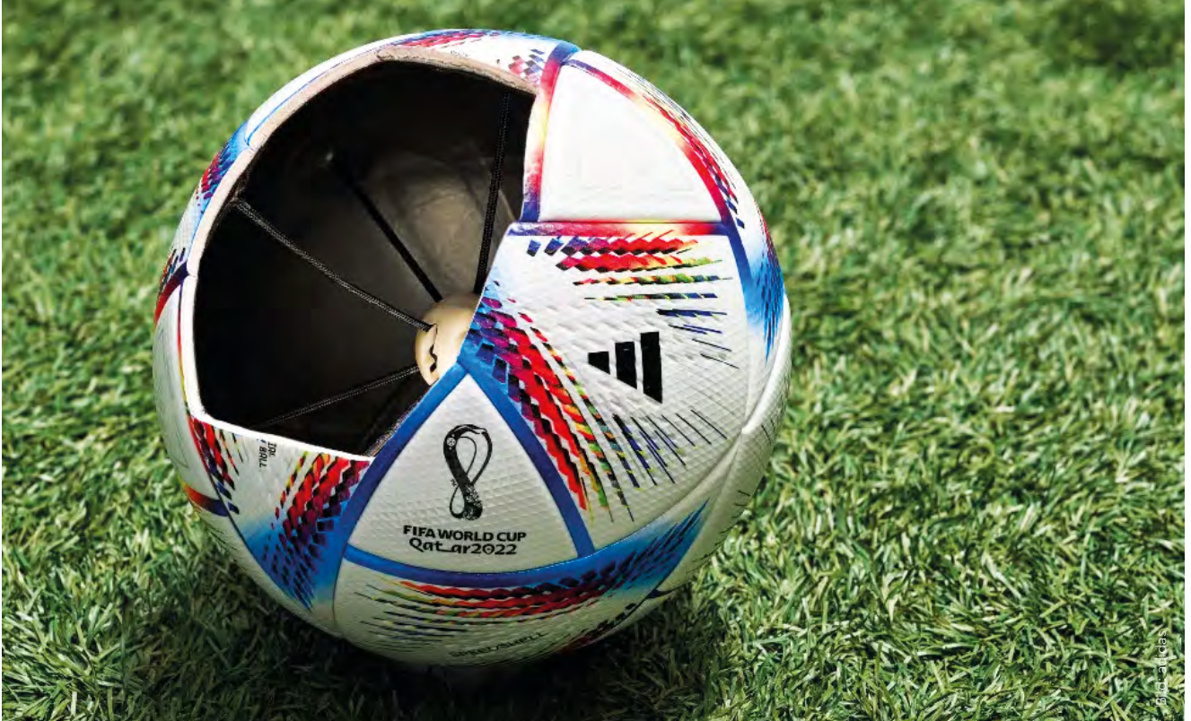
Einblick in das Innenleben des WM-Fußballs "Al Rihla": Jedes dieser neuen Sportgeräte wurde mit einem Sensorsystem ausgestattet.
